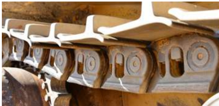
Detail of track chains during inspection at 1200 working hours. Detalle de las cadenas durante la inspección a 1200 horas de trabajo.
