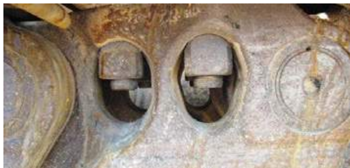
Detail of track chain during inspection at 1500 working hours. Detalle de la cadena durante la inspección a 1500 horas de trabajo.
