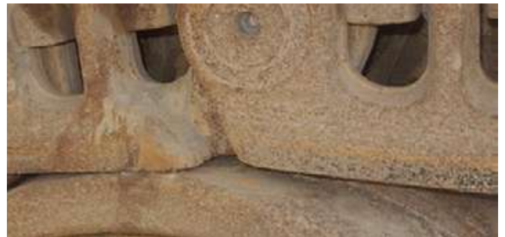
Detail of track chains during inspection at 2200 working hours. Detalhe das correntes da esteira durante a inspeção às 2200 horas de trabalho.
