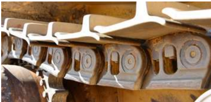
Detail of track chains during inspection at 1200 working hours. Detalhe das correntes da esteira durante a inspeção às 1200 horas de trabalho.
