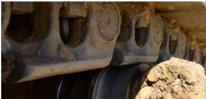
Detail of the track chains during inspection at 1300 working hours. Detalhe das correntes da esteira durante a inspeção às 1300 horas de trabalho.
