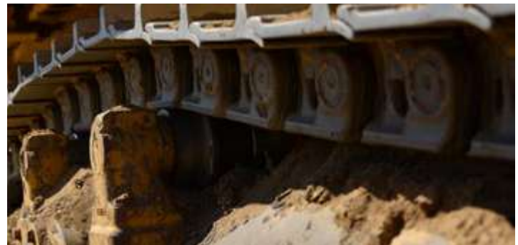
Detail of the track chains during inspection at 2400 working hours. Detalhe das correntes da esteira durante a inspeção às 2400 horas de trabalho.
