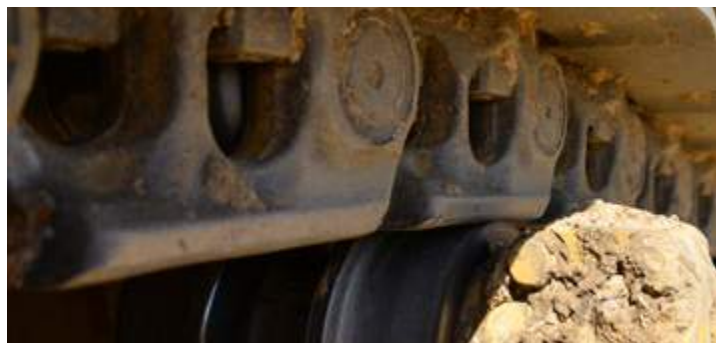
Detail of the track chains during inspection at 1300 working hours. Деталь гусеничной цепи во время осмотра при наработке 1300 моточасов.
