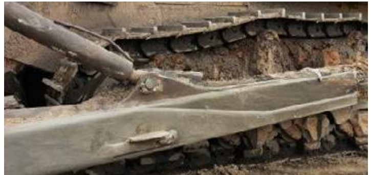
The machine stopped during undercarriage measurement at 2200 working hours. Машина остановлена во время измерения ходовой части при наработке 2200 моточасов.
