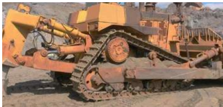
The machine stopped during undercarriage measurement at 1200 working hours. Машина остановлена во время измерения ходовой части при наработке 1200 моточасов.
