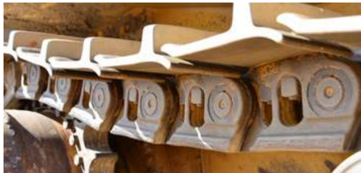
Detail of track chains during inspection at 1200 working hours. Деталь гусеничной цепи во время осмотра при наработке 1200 моточасов.
