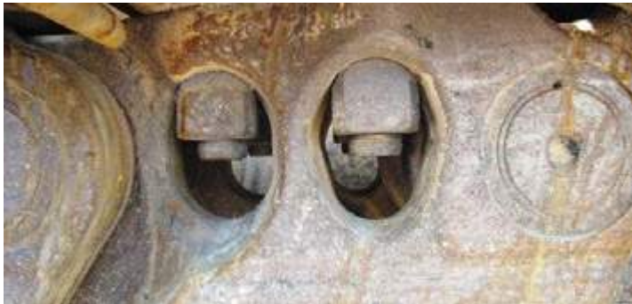
Detail of track chain during inspection at 1500 working hours. Деталь гусеничной цепи во время осмотра при наработке 1500 моточасов.
