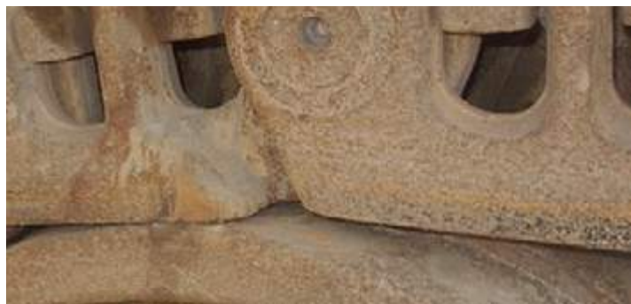
Detail of track chains during inspection at 2200 working hours. Деталь гусеничной цепи во время осмотра при наработке 2200 моточасов.
