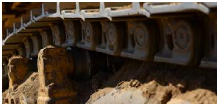
Detail of the track chains during inspection at 2400 working hours. Деталь гусеничной цепи во время осмотра при наработке 2400 моточасов.
