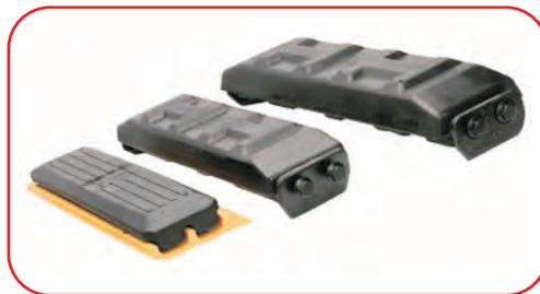
Les patins clipsés ITR sont conçus pour une utilisation sur des tuiles de chenilles en acier avec ou sans de fixation pré-percés. Pour installer les patins il suffit de déboulonner un côté du patin, de le glisser sur l'arrête et clipser le patin à la tuile. Les patins clipsés ont l'avantage de réduire le temps d'installation et d'entretien et peuvent être remplacés sur site tout en gardant la même option de tuile en acier.
