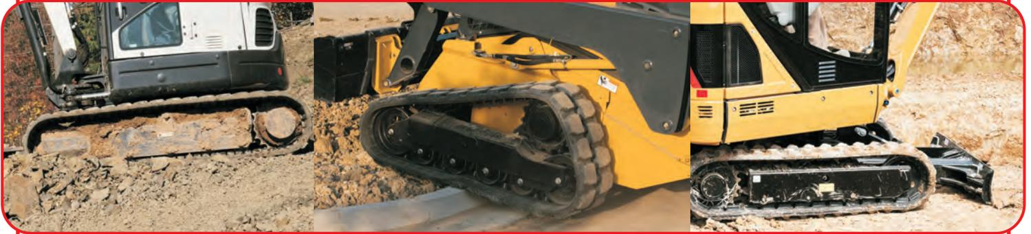
**CHENILLES** LES mini-CHENILLES EN ACIER ITR offrent une large gamme de chenilles tuilées avec tuiles soudées d'un pas de 90 mm à 101 mm et des chenilles tuilées avec tuiles boulonnées d'un pas de 135 mm. Les mini chenilles tuilées en acier ITR sont également disponibles dans une large variété de largeurs de tuiles entre 230 mm et 400 mm.
