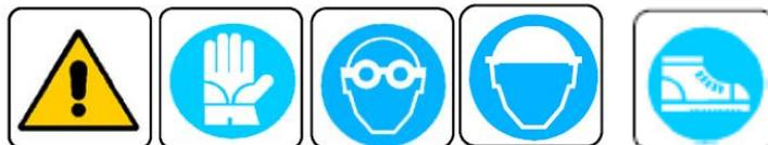
**Pour exécuter l'opération de montage / démontage de la chaîne sur le chariot, porter des gants, lunettes, chaussures et casque de sécurité**
