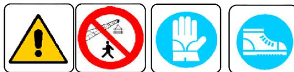
**NE PAS STATIONNER** sous les charges suspendues. S'assurer que, pendant les opérations de manœuvre pour la pose de la presse portable, personne ne se trouve à proximité immédiate de celle-ci.
