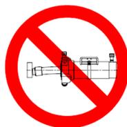
**ATTENTION :** NE JAMAIS DÉPASSER LES CHARGES NOMINALES. Ne JAMAIS essayer d'appliquer des charges supérieures à la capacité du cylindre. Le surcharges peuvent provoquer des dommages au cylindre et aux personnes.
