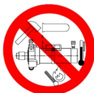
**MISE EN GARDE :** Protéger les cylindres des sources de chaleur excessive, des agents chimiques corrosifs, des flammes libres et des chocs.
